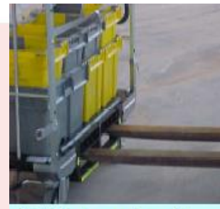
Detalle de ventana del patín
